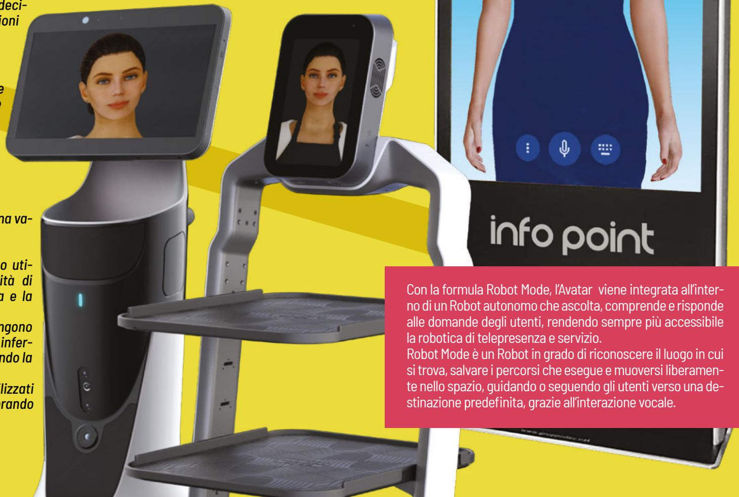
Con la formula Robot Mode, l'Avatar viene integrata all'interno di un Robot autonomo che ascolta, comprende e risponde alle domande degli utenti, rendendo sempre più accessibile la robotica di telepresenza e servizio.
